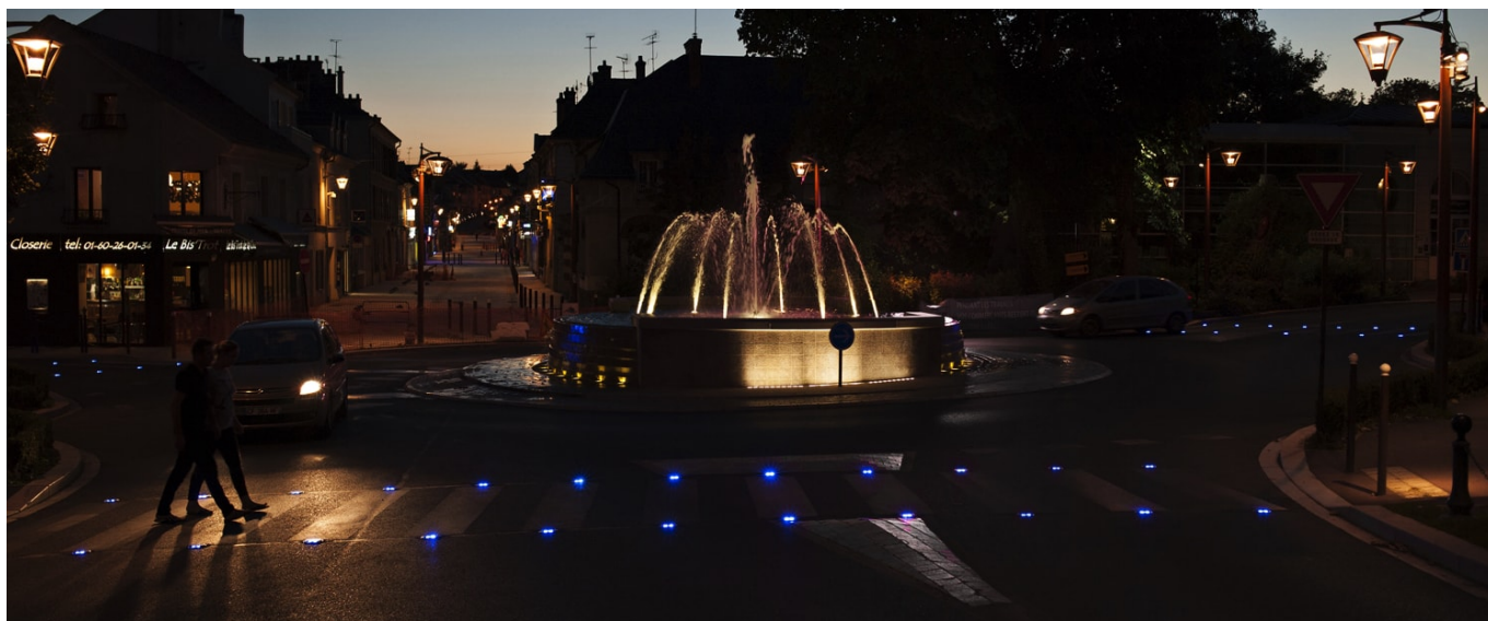
Passage piéton : balise LED routière de sécurité. Passages piétons autour d'un giratoire. Balisage de sécurité des passages piétons à Claye Souilly. Plots routiers LED encastrés ECO-848 (bidirectionnels 2x8 LED bleues fixes). Photographie : Karolina Samborska.
